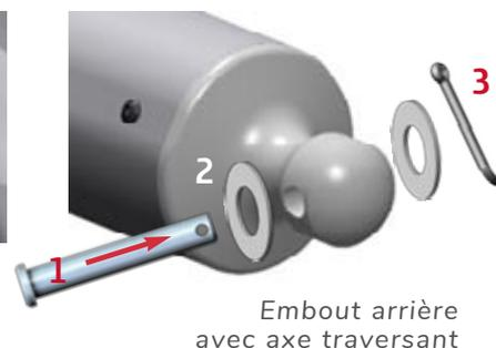
Embout arrière avec axe traversant
