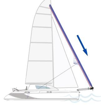
Toujours vérifier en haut si rien n'empêche l'émerillon ou la têtère de tourner librement. Une grande partie des erreurs d'enroulement se situe à ce niveau.
