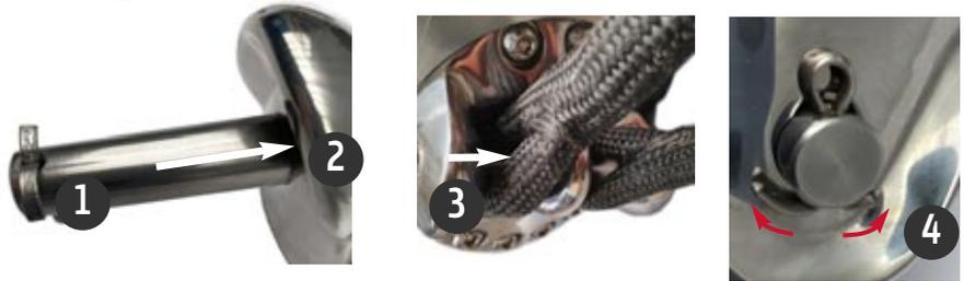
**VERSION 4500 (Axe/Vis) :** Engager l'axe sous barbe (1) dans la patte sous-barbes (2) en le connectant avec l'œil des estropes (3). Visser ensuite la 2ème vis avec du frein filet moyen (4) en s'assurant qu'elle se cale dans le lamage (5).
